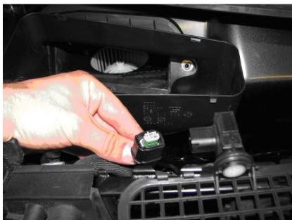
Luftgütesensor am Lüftungsschacht abstecken. Schutzgitter entfernen.
