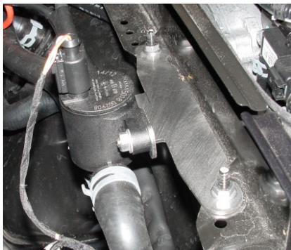
Der Serienhalter des Standheizungsventils muss abgebaut werden. Den Standheizungshalter am Fahrzeug anbringen (Stehbolzen der Karosserie verwenden) und das Standheizungsventil an den Halter anschrauben. Dazu die Mutter mit Wellscheibe M6 und die original Schrauben verwenden.
