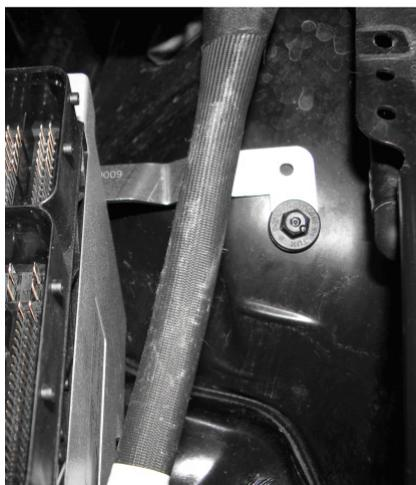
**Halter C** im Wasserkasten befestigen. Dazu die Kunststoffbundmutter verwenden.
