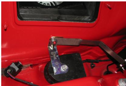
**Halter A** an den Bolzen unter dem Lüftungskasten befestigen. Hupe der Alarmanlage wieder befestigen. Falls keine Alarmanlage verbaut war ist eine zusätzliche Scheibenmutter beigelegt.
