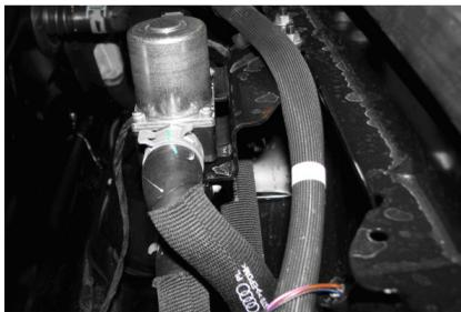
Der Serienhalter des Standheizungsventils muss abgebaut werden.
