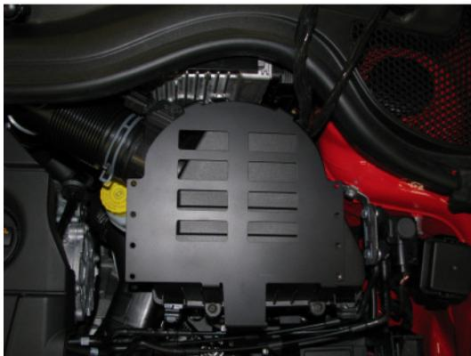
Jetzt kann der Luftfilter wieder eingebaut werden. Die Kabel des AEC müssen hinter dem Luftfilter verlegt werden.
