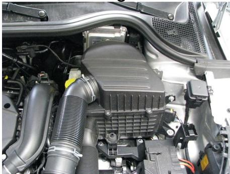
Das Luftfiltergehäuse ausbauen.
