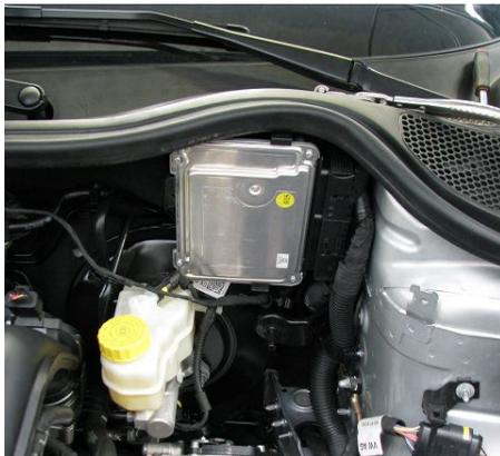
Nachdem der Luftfilter entfernt wurde, muss das Seriensteuergerät ausgehängt und abgesteckt werden.
