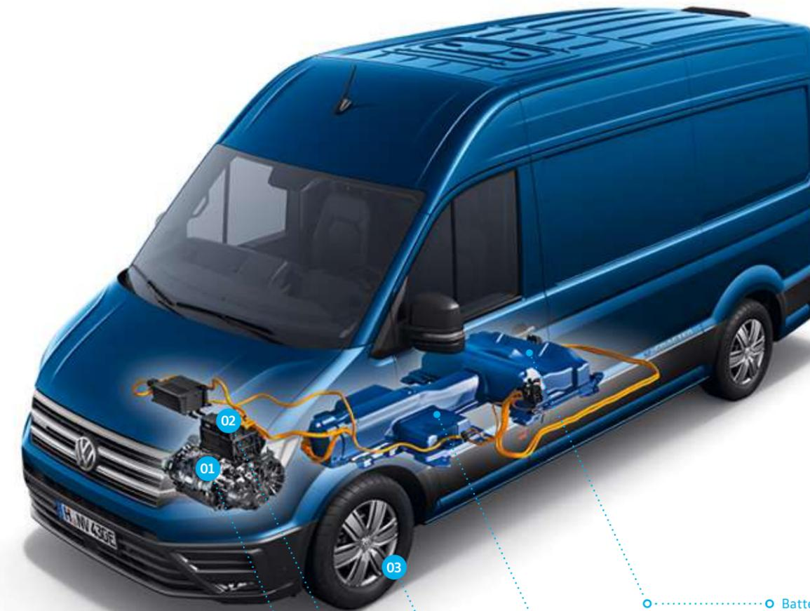
Sie benötigen das volle Laderaumvolumen für Ihre Waren? Kein Problem. Die Komponenten des Elektroantriebs sind im Motorraum und am Unterboden montiert.
